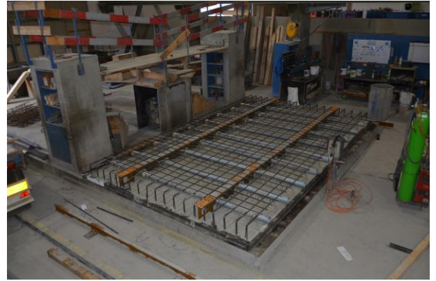
Abb.14: Dünnwandige Platte nach Einbau der Bewehrung für den zusätzlichen Aufbeton
