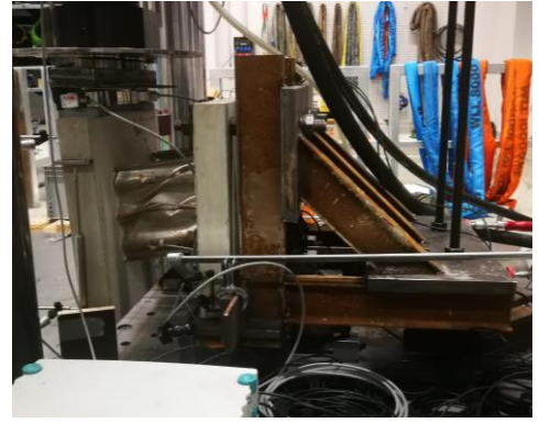
Abb.9: Versuchsaufbau mit einer Doppelwand und Kappema - Verbindungselementen
