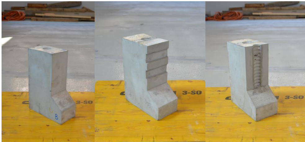
Abb.30: Glatte Oberfläche, Schubnocken, Fuge mit profilierter Nut
