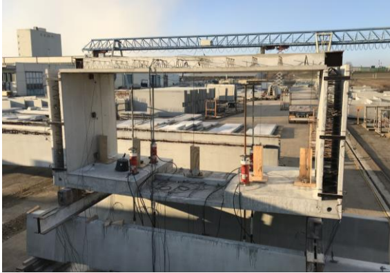
Abb.17: Belastungsversuche am Prototyp aus dem Jahr 2013
