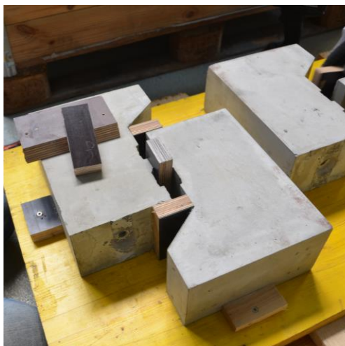
Abb.31: Fugenherstellung bei Versuchskörpern
